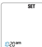
1. При включенном приборе, нажмите кнопку включения и удерживайте в течение трех секунд для входа в настройки (SET).
