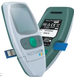
4. нажмите кнопку включения и удостоверьтесь, что код на дисплее совпадает с кодом, напечатанным на тубусе с тест-полосками;
